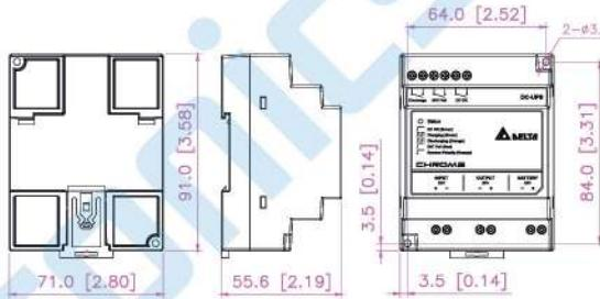
Модуль DRU предназначен для сохранения работоспособности системы управления при отключении основного питания в течение времени, определяющегося ёмкостью внешних аккумуляторов.
