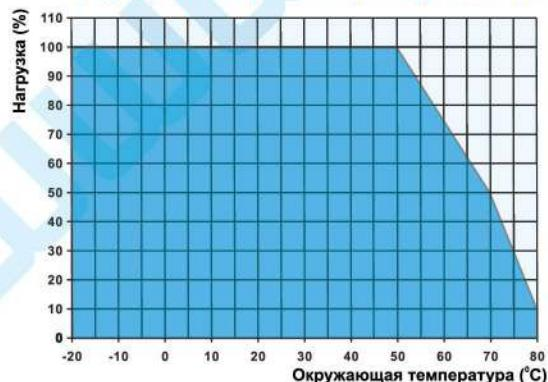
График снижения мощности PMC/PMT
