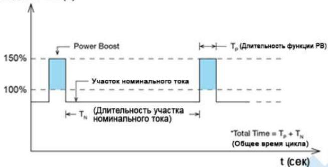
Источник питания может выдерживать перегрузки не постоянно, а в рамках рабочего цикла, состоящего из участков с номинальным выходным током и участков с повышенным выходным током. На рисунке проводится иллюстрация рабочего цикла источника питания при работе функции «Power Boost».
