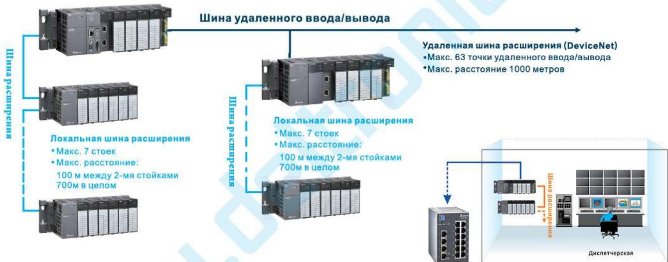
Серия AH500 позволяет организовать удаленную систему как через специальные несущие рамы и модули серии AH, так и с помощью станций удаленного ввода-вывода.
