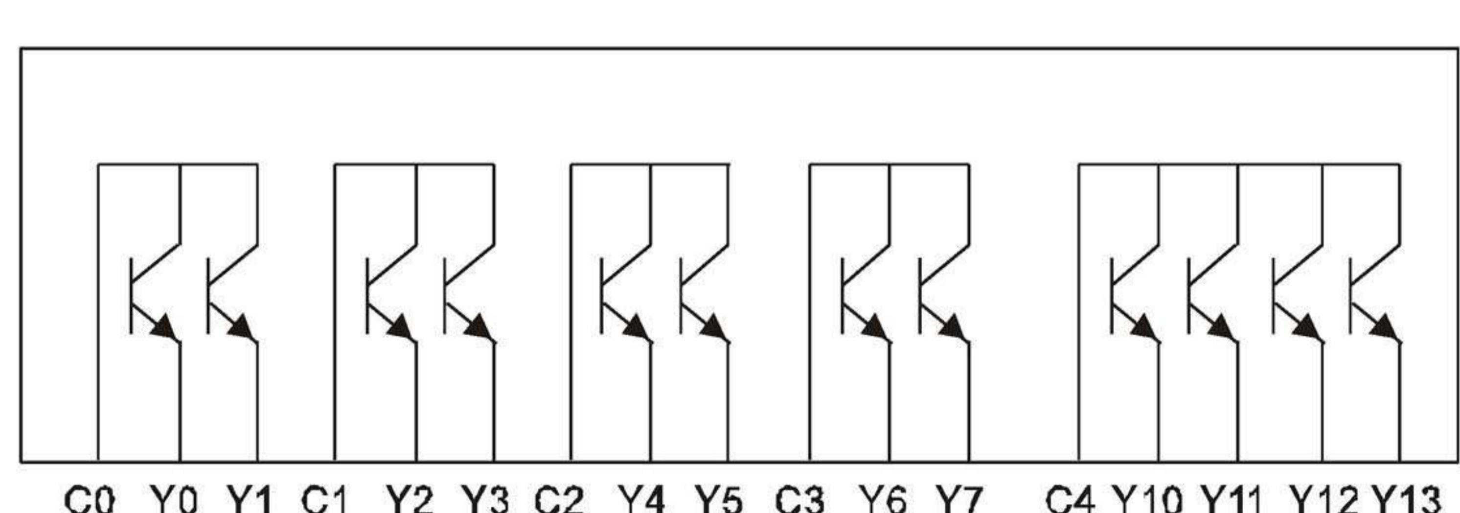
5. Для изоляции выходных цепей от основной цепи контроллера используются оптотранзисторы.
