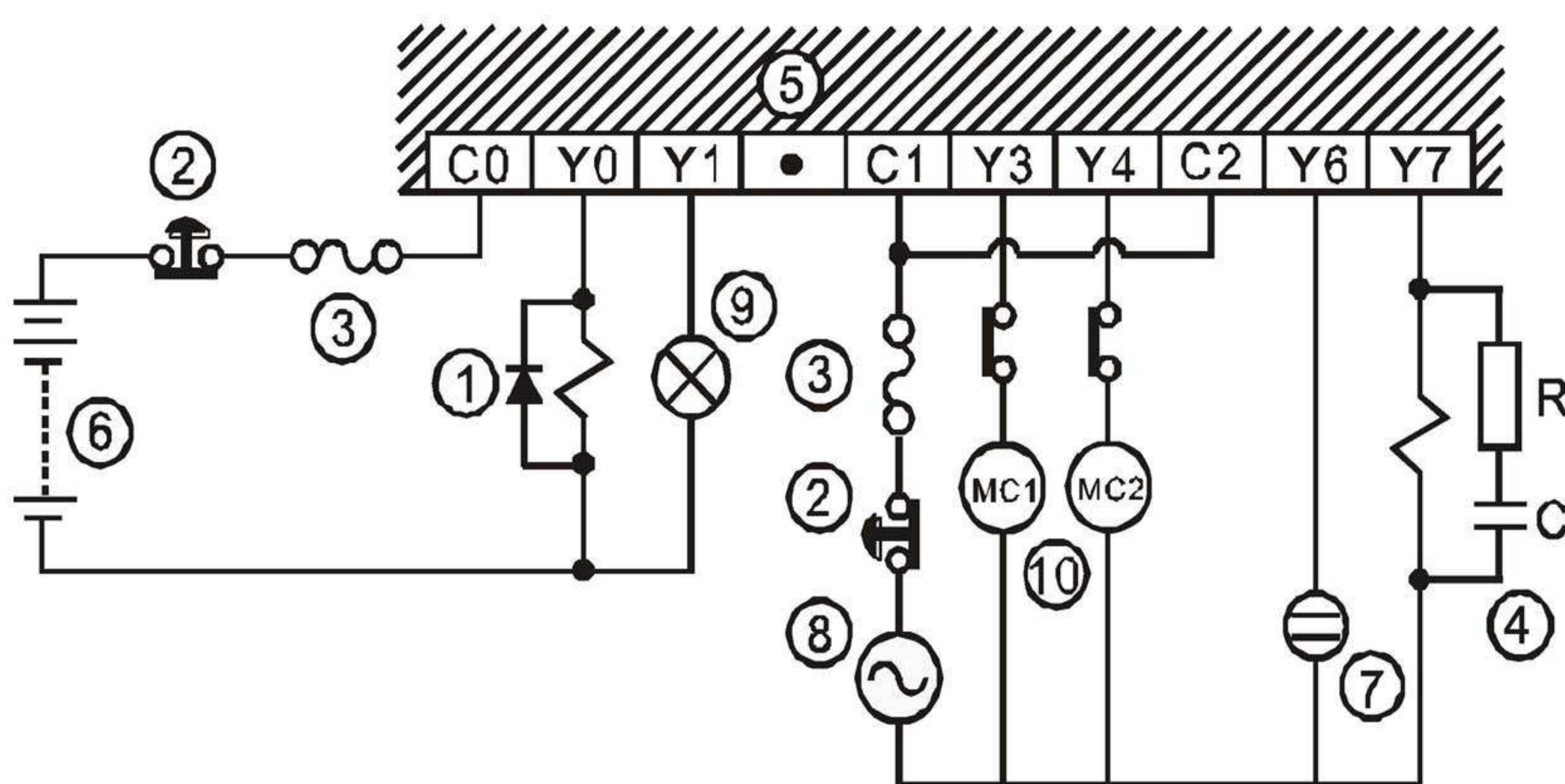
контактов реле ( $R = 100-120 \text{ Ом}$ ,  $C = 0,1-0,2 \text{ мкФ}$ )
