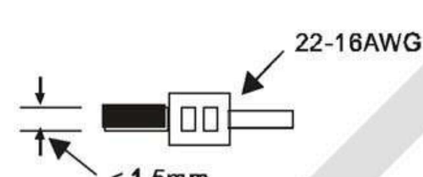
1. Для подключения используйте гибкий провод сечением 0,35-1,0 кв.мм. (22-16 AWG). Клеммы ПЛК необходимо затягивать с усилием 1,95 кг/см
