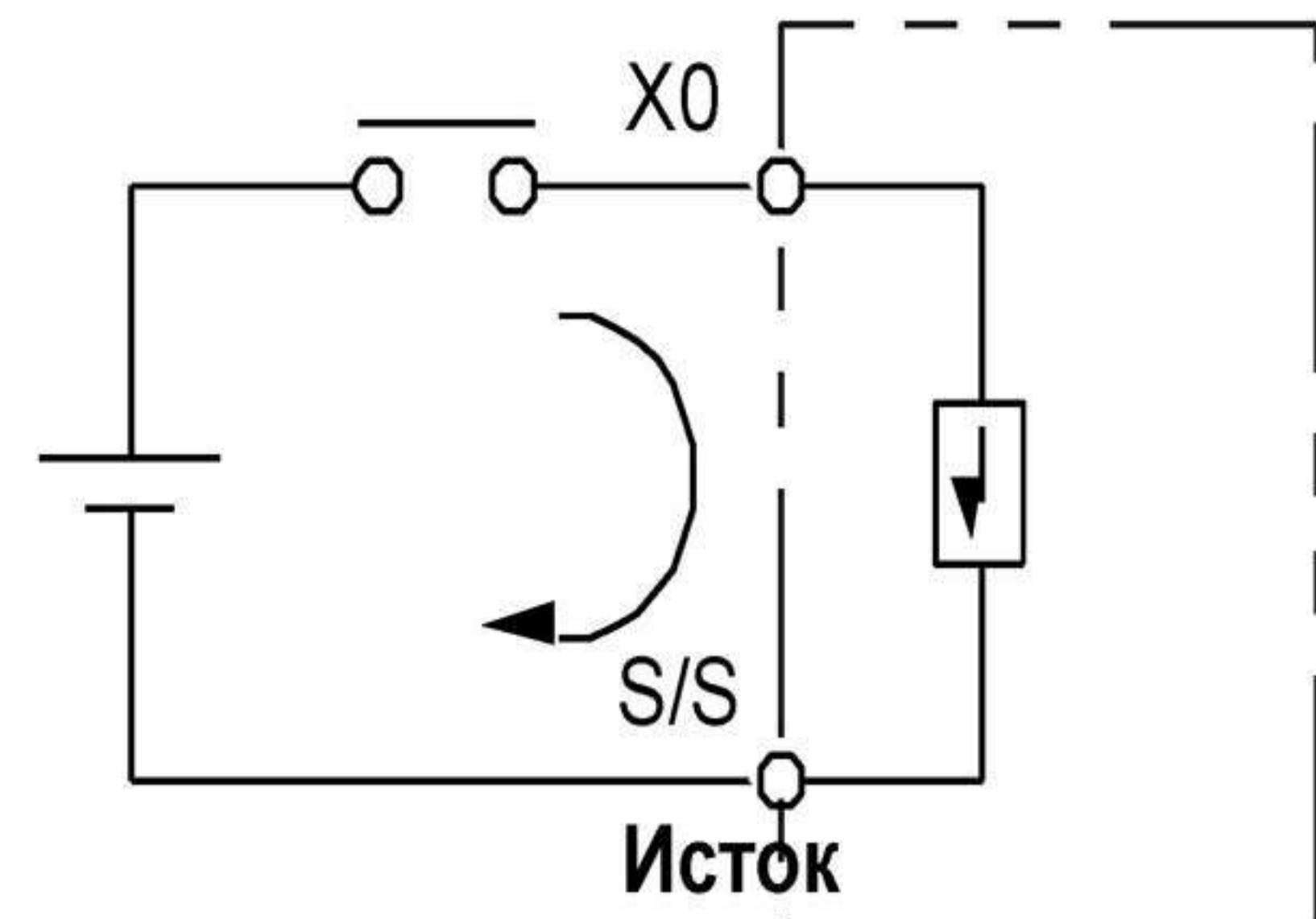
Схема подключения по NPN логике
