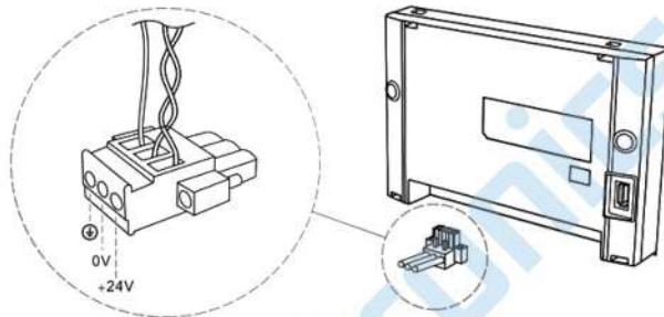
Вставляйте разъем в гнездо в соответствии с механической кодировкой.
