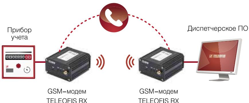
Промышленные GSM-модемы — одно из наиболее востребованных и эффективных решений для беспроводной передачи данных в системах диспетчеризации энергоресурсов. Обмен данными осуществляется по каналу GSM в режиме CSD. Решение подойдёт для систем с небольшим количеством приборов учёта или для ежемесячного снятия показаний.
