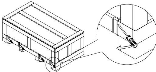
Снимите крышку ящика, извлеките пенопластовые и резиновые уплотнители и техническую документацию.
