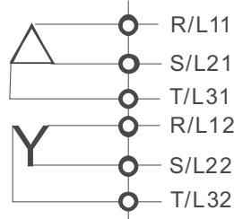
При шестипроводном питании необходимо снять перемычки с клемм R, S, T.
