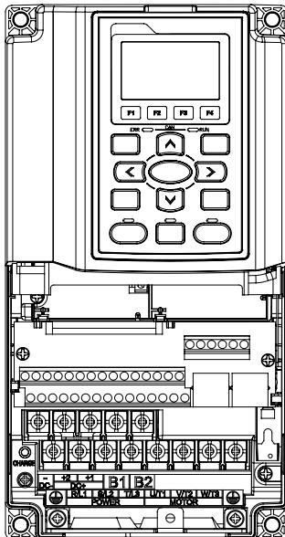
Силовые клеммы: R/L1, S/L2, T/L3, U/T1, V/T2, W/T3,  $\ominus$ , B1, B2, +1, +2, -
