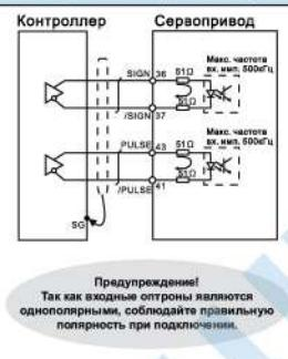
Высокоскоростной импульсный ввод (Line receiver)
